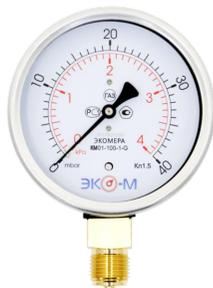
Напоромеры показывающие деформационные ЭКОМЕРА (манометры серии КМ) предназначены для измерений избыточного давления сухих, газообразных сред, неагрессивных к медным сплавам. Область применения напоромеров: газораспределение, котельное и лабораторное оборудование.
