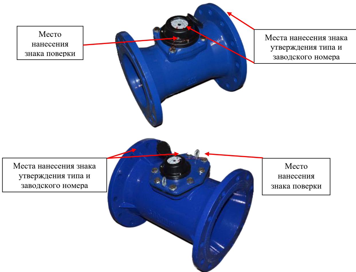
Рисунок 1 – Общий вид средства измерений с указанием мест нанесения заводского номера, знака поверки и знака утверждения типа
